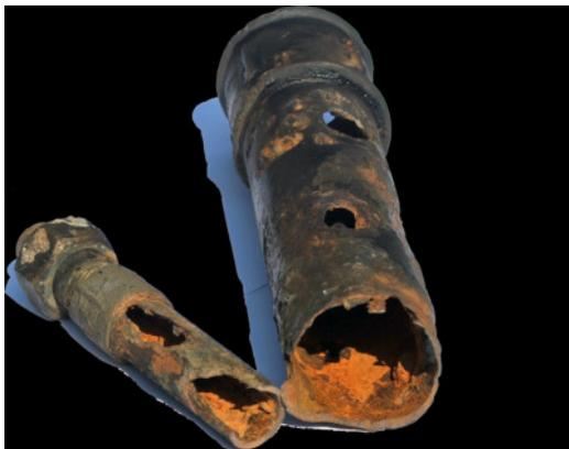
*ausgebaute Teile von durch Lochfraßkorrosion zerstörten und hochgradig inkrustierten Stahl-Hausanschlussleitungen*
